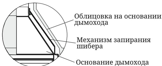
Рисунок 4. Зазор для свободного движения механизма запираания шибер
